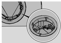
Kontroller, at den farvede beskyttelse til højre i bundbrønden er på plads.
