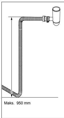
Afløbsslangen kan tillige føres til en tilslutningsstuds ved køkkenvaskens vandlås. Tilslutningsstudsens indvendige diameter skal mindst være 14 mm.
