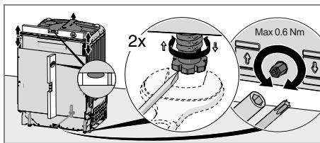
4. Kontroller at det er en luftspalte på minst 3 mm mellom undersiden av arbeidsbenken og overkanten av oppvaskmaskinen.
