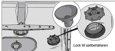
När saltet tar slut, skruva av locket och fyll behållaren med salt. Vatten behövs bara första gången! Torka rent och skruva åt. Kör ett program så att eventuellt salt i diskmaskinen sköljs bort.
