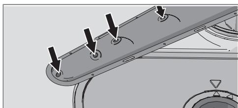
For at gøre rengøringen lettere kan du løsne spulearmene. Glem ikke at montere dem ordentligt fast bagefter.
