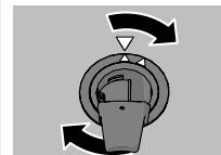
Diskresultatet kan påverkas om silarna inte är rätt monterade. Observera att diskmaskinen inte får användas utan att silarna är monterade!
