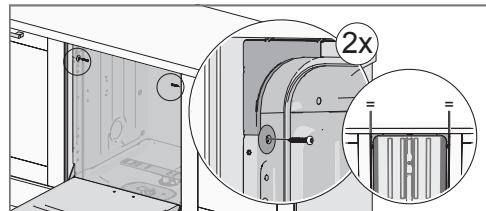
Kontrollera efter fastsättning att de främre foterna ligger an mot golvet.
