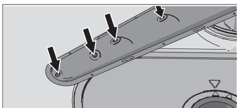
För att underlätta rengöringen kan du lossa spolarmarna. Glöm inte att montera fast dem ordentligt efteråt.
