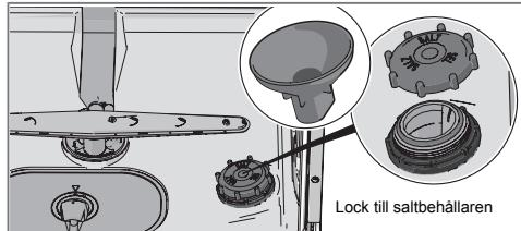
1. Skruva bort locket till saltbehållaren.
