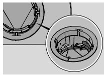
Kontroller at den fargede beskyttelsen til høyre i brønnen er på plass.
