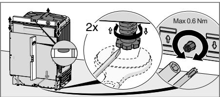
4. Kontrollera att det är en luftspalt på minst 3 mm mellan arbetsbänkens undersida och diskmaskinens överkant.
