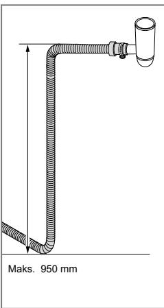
Avløpsslangen kan også føres til en tilkoblingsnippel ved kjøkkenvaskens vannlås. Tilkoblingsnippelens innvendige diameter må være minst 14 mm.
