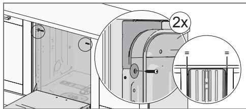
Kontroller, at de forreste fødder hviler på gulvet, når du har skruet maskinen fast.
