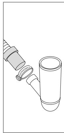
Avloppsslansen kan även ledas till en anslutningsnippel vid diskbänkens vattenlås. Anslutningsnippelns invändiga diameter måste vara minst 14 mm.
